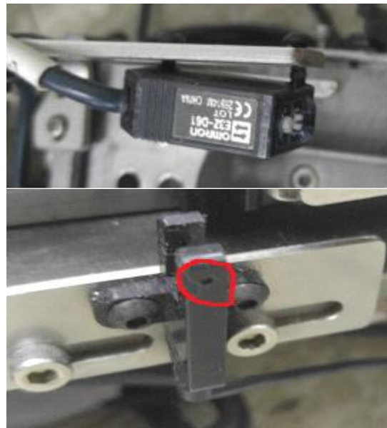
<그림 4-8> 10만 번 테스트 후 Gripper 홀더 및 sensor
