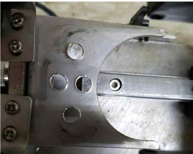
<그림 4-7> 10만 번 테스트 후 테스트기
