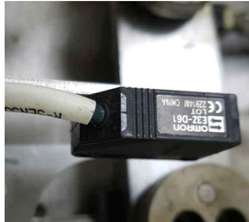
<그림 4-4> 5만 번 테스트 후 Gripper 홀더 및 sensor
