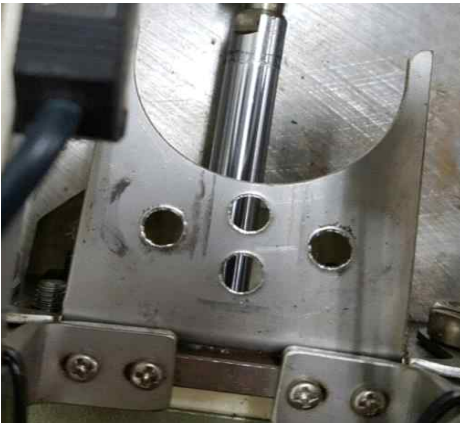
<그림 4-6> 8만 번 테스트 후 Gripper 홀더 및 sensor
