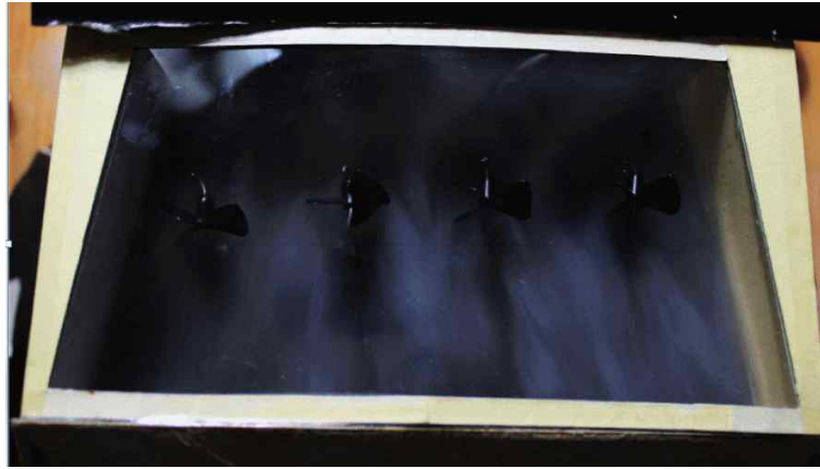
그림 4.13 모형 내부에 프로펠러를 장착 하였을 때
