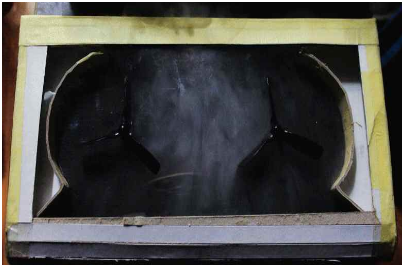
그림 4.11 내부에 반구형 프로펠러를 양쪽에 설치하였을 때
